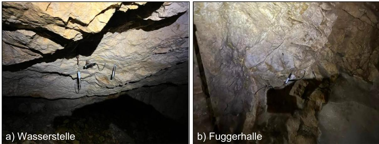
**Abb. 5:** Fotoaufnahmen von den in der Schellenberger Eishöhle ausgebrachten Pt1000 Temperatursensoren mitsamt der Datenlogger an den Messstellen der a) Wasserstelle und b) Fuggerhalle.
